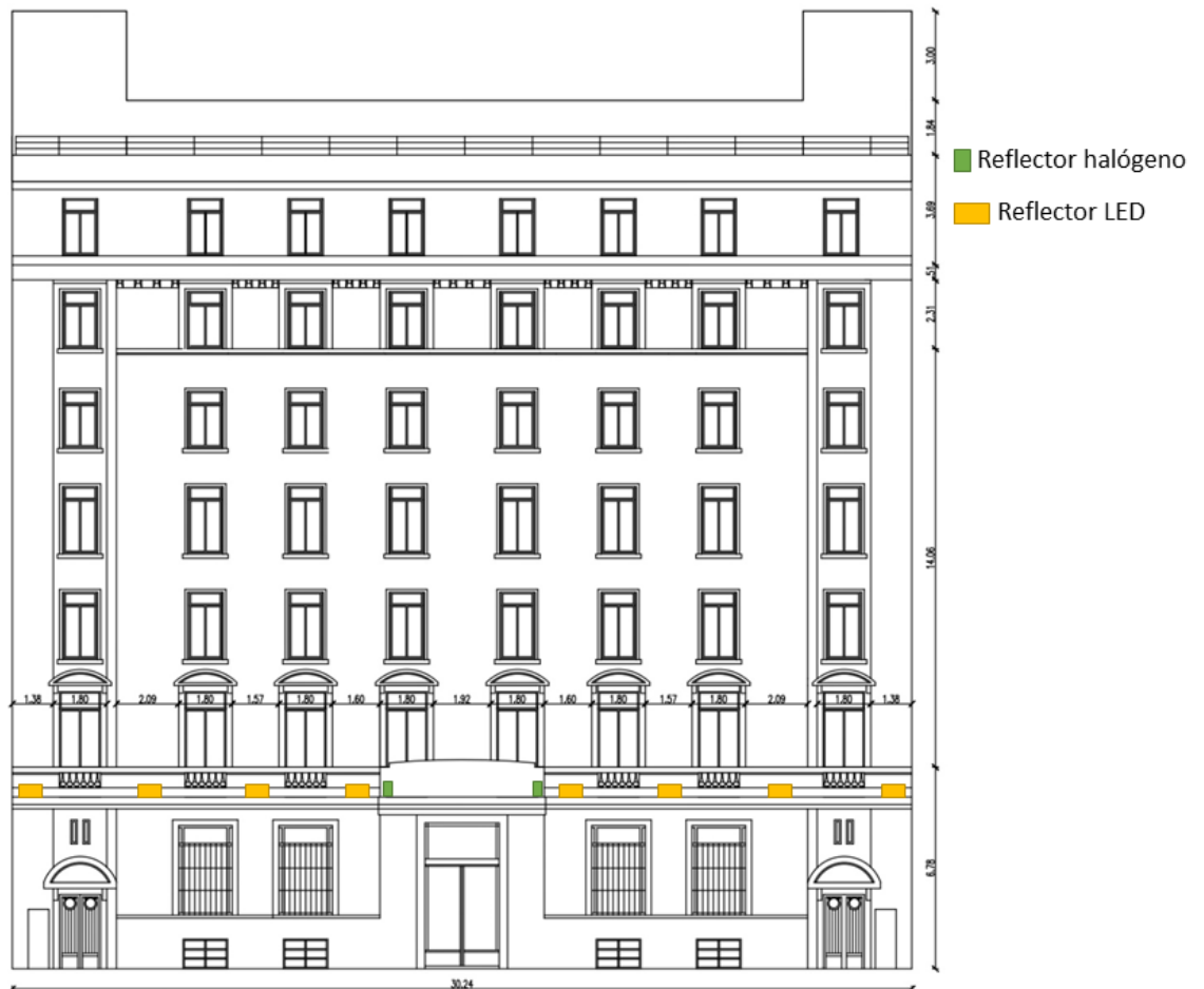
Ubicación de artefactos a desinstalar.
